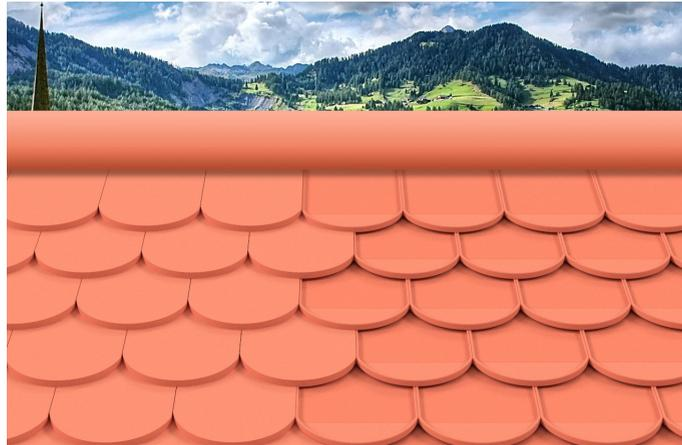
Das von paXos entwickelte Solarbiberschwanzmodul hat die gleiche Optik wie klassische Biberschwanzziegel und ermöglicht dadurch, Dachflächen von denkmalgeschützten Bauten für die Energiegewinnung (PV und Solarthermie) zu nutzen. Die integrierte Hinterlüftung sorgt für eine Kühlung der Solarzellen, wodurch die Lebensdauer des gesamten Systems deutlich erhöht wird. Das Modul ist einfach zu verlegen und einzeln aus dem Verbund zu lösen. Es stehen mehrere Designs und Farben zur Verfügung.
